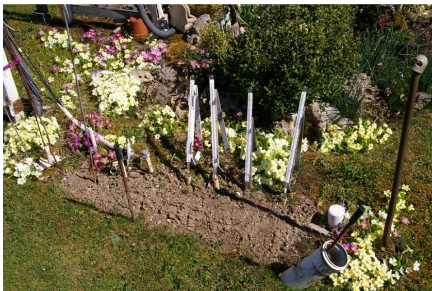
Zur umfassenden Klimadokumentation gehört auch das Messen der Temperaturen im Erdboden. Das Meßfeld wird vom Bewuchs freigehalten. Die Thermometer und die elektronischen Meßfühler messen in 3; 5; 10; 20 und 50 Zentimeter Erdbodentiefe. Fotos: Guido Wekemann
